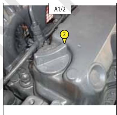
**!** Lai izvairītos no izšķakstīšanās un apdegumu riska, pirms skavas izņemšanas pagaidiet, līdz siltumdzinējs atdziest, lai dzesēšanas šķidrums nosētos. Ja dzesēšanas šķidrums ir ļoti karsts, nepapildiniet to ( $80^{\circ}\text{C}$ ). Ārkārtas gadījumā kā dzesēšanas šķidrumu jūs varat izmantot ūdeni, pēc iespējas drīzāk to iztukšojot un aizvietojot ar dzesēšanas šķidrumu (skatiet (skatiet: 3 - APKOPE: E1 – DZESĒŠANAS ŠĶIDRUMS)).
